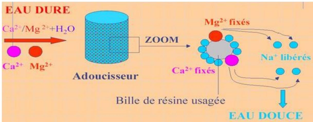
Cette réaction est réversible avant la saturation des résines en ion calcium ( $\text{Ca}^{++}$ ), magnésium ( $\text{Mg}^{++}$ ), fer ( $\text{Fe}^{++}$ ), aluminium ( $\text{Al}^{+++}$ ), une régénération est déclenchée par l'intermédiaire du sel  $\text{NaCl}$ , le  $\text{Na}^+$  se fixe à nouveau sur les résines, le  $\text{Cl}^-$  est rejeté à l'égout avec ces ions positifs arrêtés. C'est la **phase de régénération** qui permet de remettre les adoucisseurs en concentration
